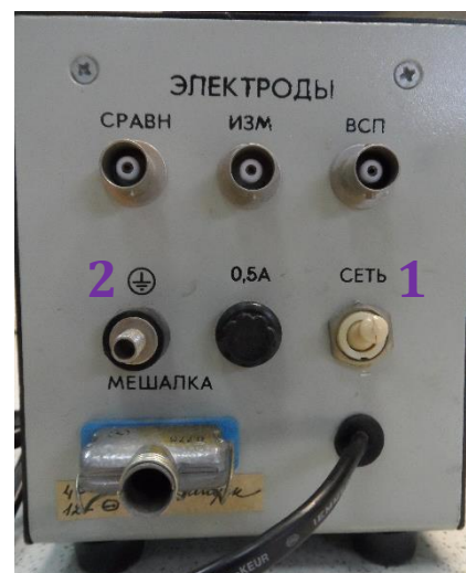
Рис. 3. Задняя панель установки с ВДЭ. Тумблером 1 включают установку в сеть, токоотвод 2 служит для заземления установки.
