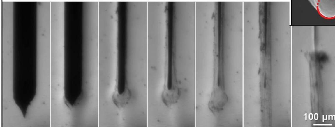
Травление вольфрамовых зондов: подкисление, образование вольфрамовой кислоты.
