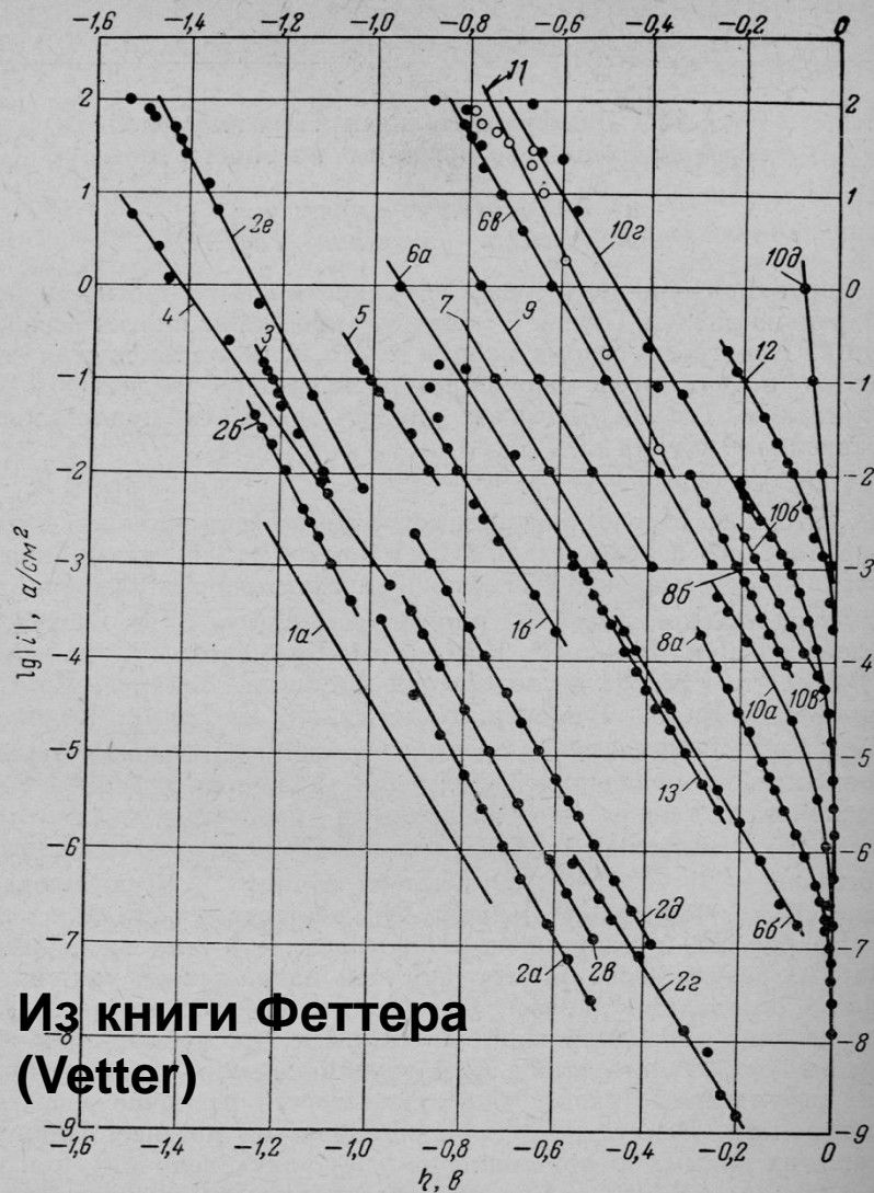
Рис. 209. Зависимость катодного перенапряжения водородного электрода от плотности тока для различных металлов и электролитов по измерениям разных авторов:
