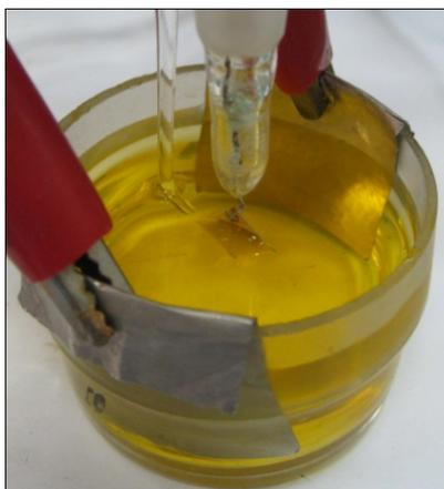
7. Подсоединить ячейку к прибору Autolab (рабочий электрод подключается к проводу WE (working electrode) прибора, вспомогательный – к проводу CE (counter electrode), электрод сравнения – к проводу RE (reference electrode)) зажимами типа “крокодил”.
